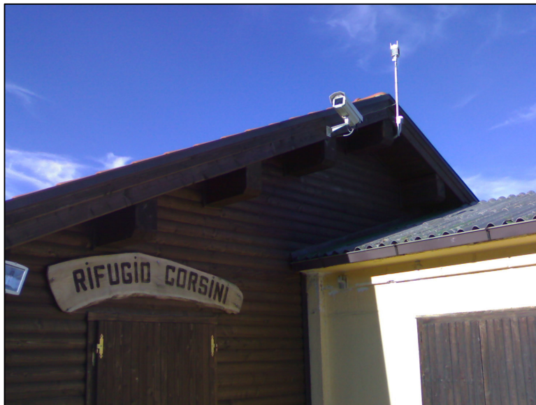
SITO DI INSTALLAZIONE Rifugio Corsini – Monte Nerone: sistema webcam integrato con sensore meteo
